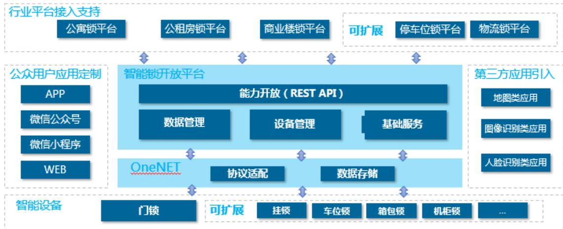
**能力封装与身份认证：**对内部能力进行封装标准化，将接口封装成提供标准RESTful风格的API接口，便于外部系统的对接；在能力开放层前置身份认证，不但可以提高系统安全性，而且可以减轻未授权流量对后端服务的压力。
