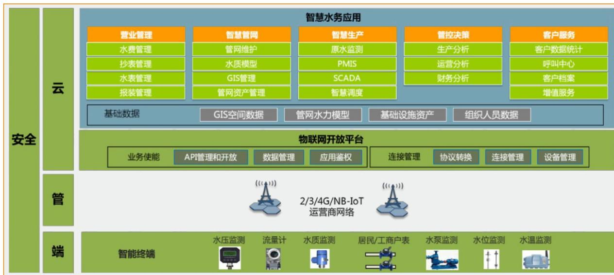
基于 NB-IoT 的智慧水表解决方案按照云、管、端+ 安全的系统架构来建设，以满足 ICT 未来演进的需求。方案包括终端层、网络层、物联网云平台和水务应用层等几个层面，通过物联网、云计算、大数据等技术将各个层面整合统一为有机的整体，支撑智慧水务应用的构建和快速上线。
